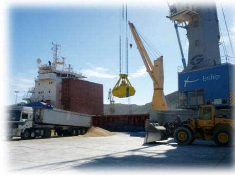
*Cucharas o Grapines utilizados para la carga y descarga de Graneles sólidos totalmente estancos para evitar caídas al mar de material*
