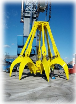
Pulpo utilizado para mejorar el sistema de carga de buques de chatarra Cucharas o Grapines utilizados para la carga y descarga de Graneles sólidos totalmente estancos para evitar caídas al mar de material
