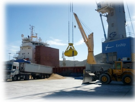
Pulpo utilizado para mejorar el sistema de carga de buques de chatarra Cucharas o Grapines utilizados para la carga y descarga de Graneles sólidos totalmente estancos para evitar caídas al mar de material
